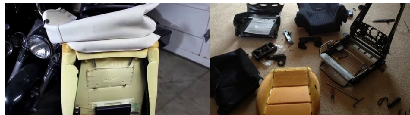
Le componenti in poliuretano schiumato presenti all'interno dei veicoli sono profondamente integrate alla struttura portante
